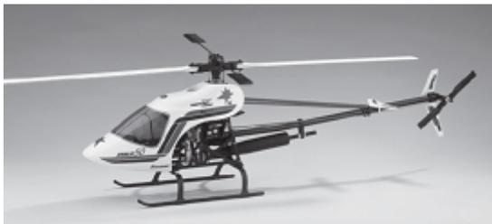
Comme exemple, nous utiliserons l'hélicoptère STAR-LET 50 *GRAUPNER*, avec une commande de plateau à 3 points répartis à 120°, rotor tournant dans le sens horaire, réglage débutant, avec courbe des gaz en « douce », sans gyroscope en mode Heading-lock, sans intervention gyroscopique coté émetteur, et sans variateur.
