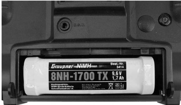
Pour retirer la batterie d'émission, ouvrir d'abord le couvercle du logement au dos du boîtier de l'émetteur en le poussant dans le sens de la flèche. Déconnecter la prise de la batterie d'émission en tirant avec précaution sur les fils ou tirer sur le dessus du corps de la prise avec un ongle. Ne pas tirer la prise vers le haut ou vers le bas, mais le plus horizontalement possible.
