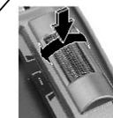
L'encodeur à l'état pressé permet de changer entre les différentes lignes d'un menu. Pour une meilleure maniabilité, tourner l'encodeur à l'état pressé par l'extrémité supérieure du cylindre.
