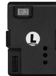
Module HF (Vu de l'arrière) avec un quartz *GRAUPNER* enfiché. Le quartz d'émission porte la désignation "T" (Transmitter).
