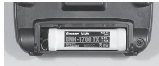
Débranchez avec précaution la prise de l'accu d'émission en tirant doucement sur le cordon ou tirez la prise avec l'ongle par le dessus de la prise. Ne tirez pas la prise vers le haut ou vers le bas, mais parallèlement au dessus de l'émetteur.
