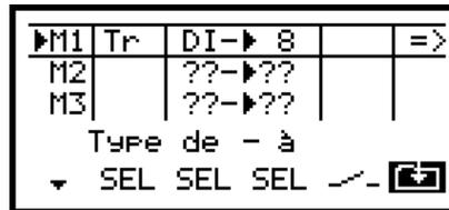
... et enregistrez un mixage „Tr DI → 8“. Dans la colonne „Type“, choisissez le réglage „Type“ pour que le trim de la direction puisse agir sur les deux Servos de commande de la direction.
