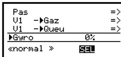
En partant des réglages spécifiques à chaque phase de vol, on peut faire varier l'efficacité du gyroscope, grâce à un élément de commande attribué dans la ligne „Gyr“ du menu »**Réglages des éléments de commande**«, par exemple CTRL 5.
