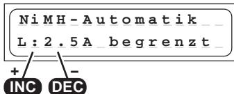
Der maximale Ladestrom muss vor dem Anstecken des zu ladenden Akkus mit den INC / DEC-Tasten von 0,1A -5A bzw. ohne Begrenzung so eingestellt werden, dass der max. zulässige Ladestrom des Akkus nicht überschritten werden kann. Laden Sie die Akkus auf keinen Fall mit mehr als 2C! Bsp.: NiMH 6N-4200, max. Ladestrom 8,4A, empfohlener Schnellladestrom für Graupner-Akkus 4,2A. Senderakkus müssen auf max. 2A Ladestrom begrenzt werden!
