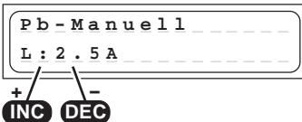
Bei diesem Programm wird **vor** dem Anstecken des zu ladenden Akkus mit den INC / DEC-Tasten der für den Akku **maximal zulässige** Ladestrom (maximal Ladestrom) eingestellt.
