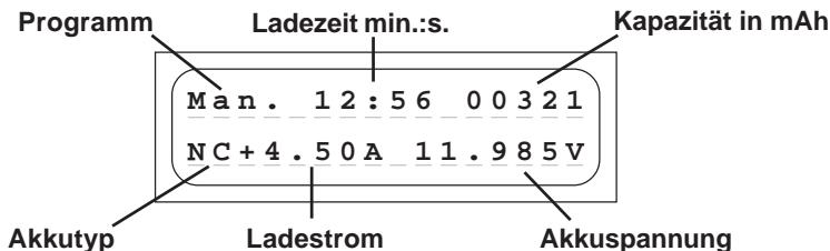
Die während der Ladung / des Balancievorganges wichtigen Daten werden übersichtlich auf der zweizeiligen Flüssigkristallanzeige wiedergegeben und sind bis zum Abklemmen des zu ladenden Akkus sichtbar. Wird ein weiterer Akku geladen sind die vorher angezeigten Werte nicht mehr abrufbar.
