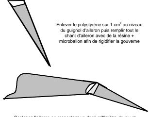
Scotchez l'aileron en respectant un demi millimètre de jeu et vérifier que le débattement vers le bas s'obtienne par glissement de l'intrados de l'aileron sous l'intrados de l'aile. Au besoin poncer un peu pour qu'il n'y ait pas de frottements.
