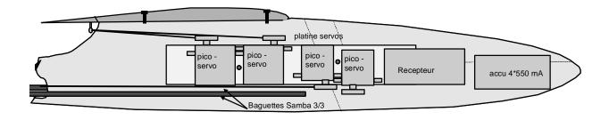
La platine est alors glissée par l'ouverture de l'ogive dans le fuselage et vissée par 2 vis à bois à tête plate, directement par l'extérieur, sur le flan droit du fuselage.
