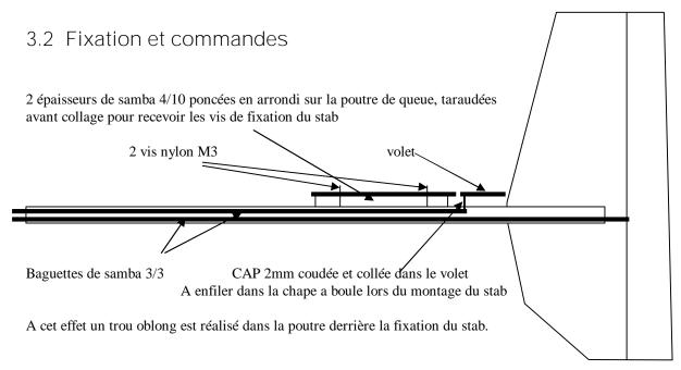
Des morceaux de tige filetées sont encastrées et collées dans les extrémités des tiges de commandes. La commande de profondeur reçoit une chape à boule, et la commande de dérive une chape plastique, un guignol classique est fixé dans le volet de dérive.
